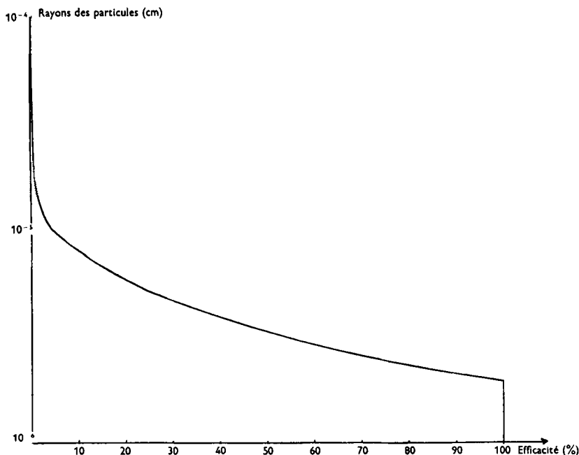
FIG. 1. Courbe d'efficacité du capteur de Zélény.
