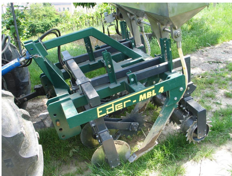
Abb. 1: Mulchbodenlockerer mit Düngerkastenaufsatz
