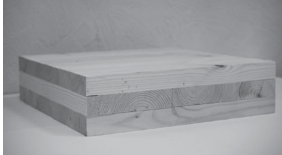
Il. 8. Trzywarstwowy CLT, Autor: Rain Alexander Dmitrievich, wolny dostęp, CC BY-SA 4.0, https://commons.wikimedia.org/w/index.php?curid=65449630 (dostęp 27.09.2024).
