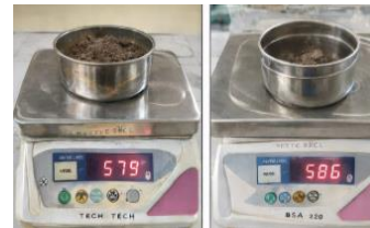
(d) Moisture content determination of Atterberg samples
