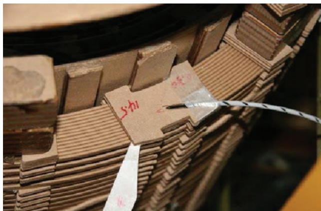
Slika 7: Primjer postavljenog fiber optičkog senzora na razmaknicu između diskova [5]
