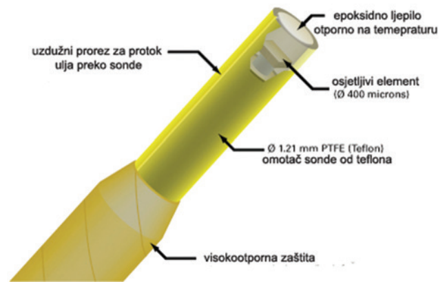
Slika 2: Izgled fiber optičkog senzora za mjerenje temperature [3]
