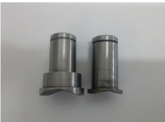
Slika 12: Usporedba nove (lijevo) i stare (desno) izvedbe osovinice
