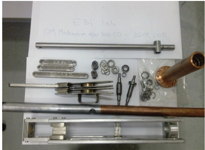
Slika 7: Dijelovi mehanizma za dvostruko kretanje kontakata nakon prvog ciklusa ispitivanja
