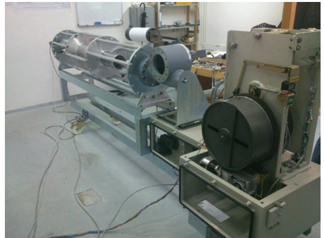
Slika 3: Ispitni model prekidača s mehanizmom za dvostruko kretanje kontakata
