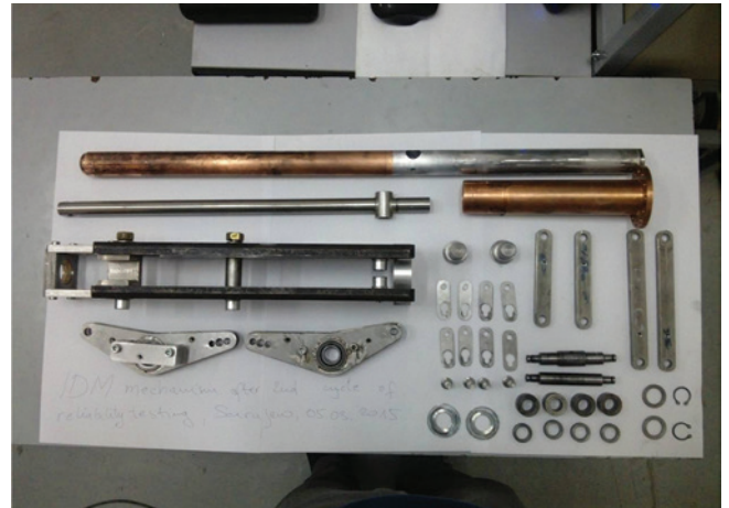
Slika 13: Dijelovi mehanizma za dvostruko kretanje kontakata nakon drugog ciklusa ispitivanja
