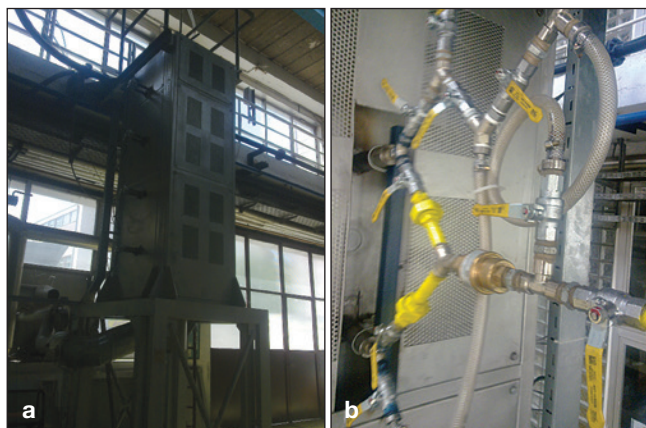
Slika 1: a) Izgled eksperimentalne linije AUCR: frontalni pogled sa uočljive četiri grijne zone i termoparovima za mjerenje temperature reakcione cijevi i vođenje procesa; b) Segment linije koji omogućuje ispitivanje različitih tehnologija sagorijevanja: stepenasto sagorijevanje po dovodu goriva i/ili zraka (eng. fuel-air-staging ) te tehnologije sa dodatnim gorivom – zemni plin
