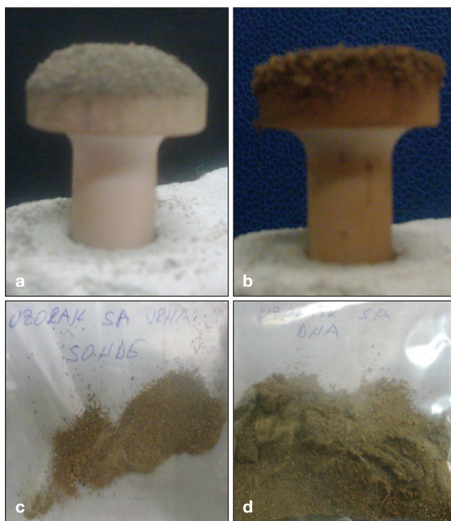
Slika 12: Primjeri uzoraka depozita i šljake za ispitne režime pri 950 do 1250 °C
