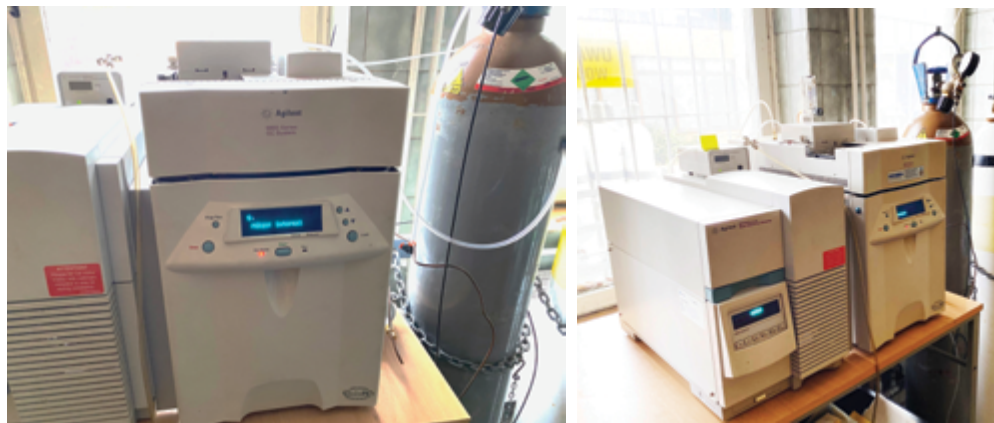
Rys 2–3. Chromatograf gazowy z detektorem TCD i spektrometr masowy w zestawie AGILENT GC 6850/MSD 5973 w KTPP AMW.
