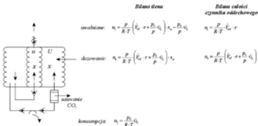
Rysunek 1. Bilans molowy gazów w przestrzeni oddechowej aparatu nurkowego
