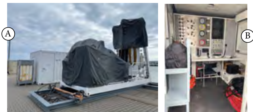
Rys. 4. Dzwon nurkowy typu mokrego: A – konfiguracja do pracy z uzbrojonego nabrzeża; B – wnętrze kontenera kierowania pracami podwodnymi wraz z wyposażeniem
