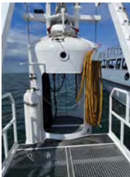
Rys. 5 Wiązka bellmana na zewnątrz korpusu dzwonu typu mokrego
