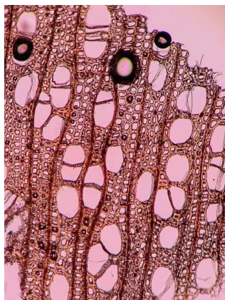
Foto nr. 14 - Secțiune transversală la stereobinocular Sursa: Conf. Univ. Dr. Livia Bucșa
