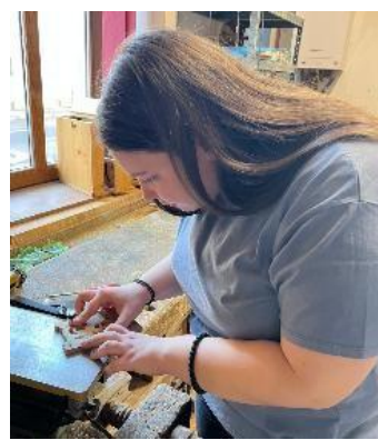
Foto nr. 20 - Traforarea mecanizată
