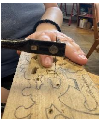
Foto nr. 19 - traforarea manuală
