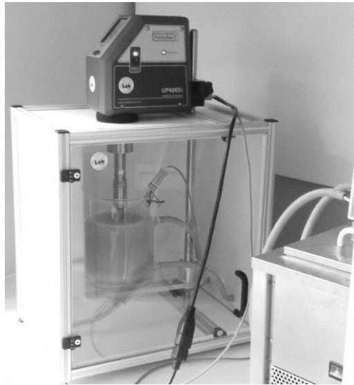
Fig. 6. Cavitation test stand
