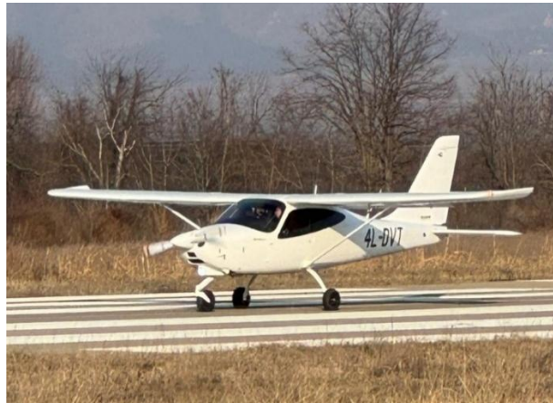
Fig. 9. Tecnam P2008JC (MTOW 650 kg, Max cruise speed 215 km/h)
