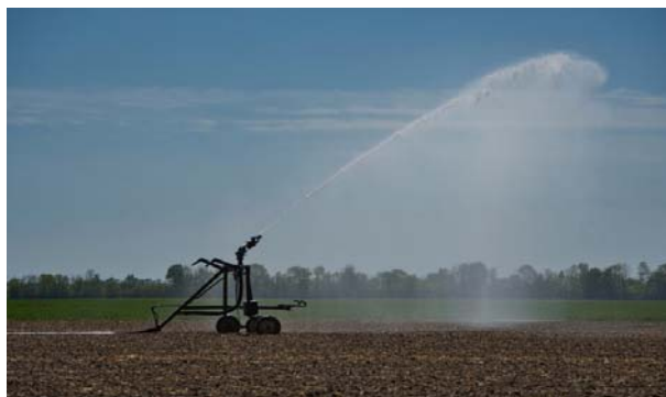
Figure 8. Aspersor pentru irigatii mobil, cu roti, cu raza de udare, stropire, mare sau medie.
