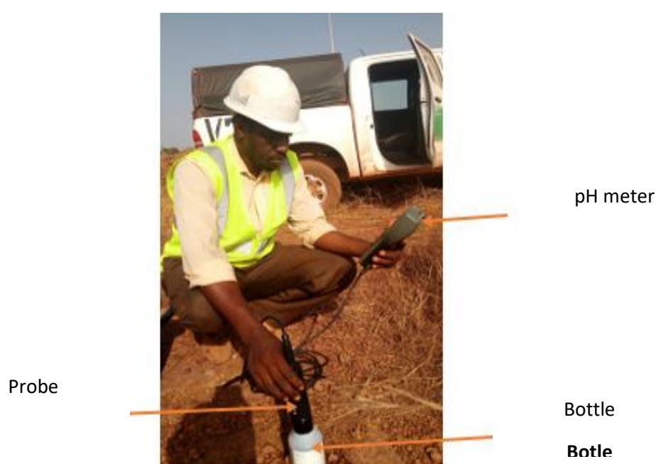
Figure 4. Smulti parameter wave Hanna HI-9829
